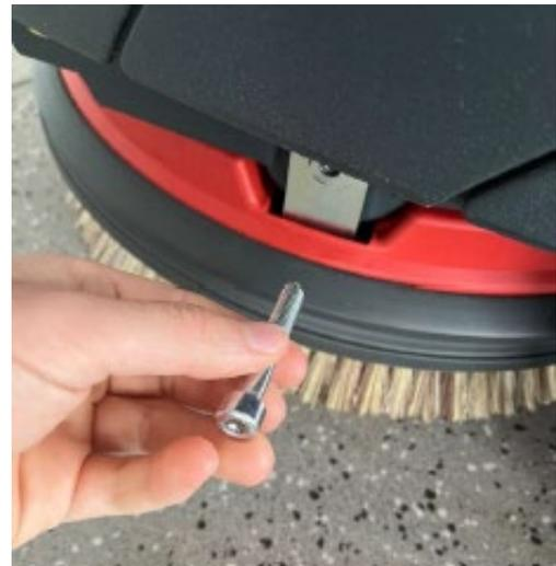
Schraube an Bürstenkopf lösen. Die Schraube wird nicht mehr benötigt.
