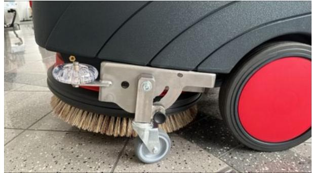
Fertig montiertes Transportrad mit Druckfeder.
